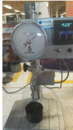
Fotografía 9. Ensayo de penetración
