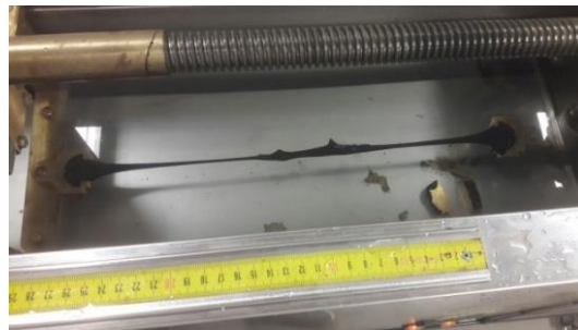
Fotografía 12. Fin ensayo de ductilidad
