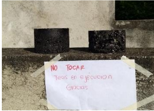
Fotografía 31. Muestras expuestas al sol, izquierda convencional y derecha drenante
