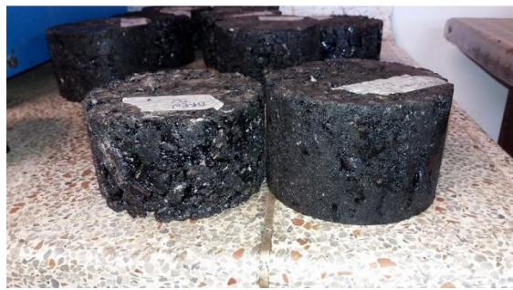
Fotografía 24. Muestra drenante a la izquierda y convencional a la derecha.
