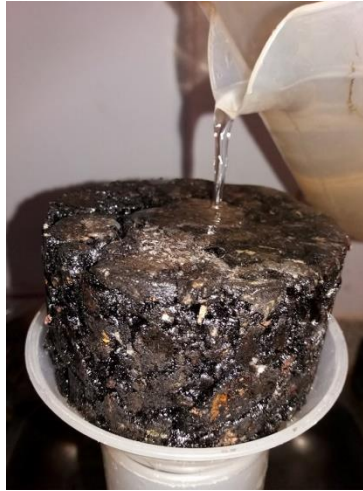
Fotografía 25. Prueba de permeabilidad
