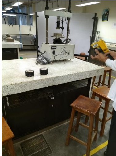
Fotografía 29. Toma de temperatura en el laboratorio. Drenante (izquierda), convencional (derecha)
