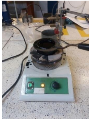
Fotografía 13. Ensayo con la copa Cleveland
