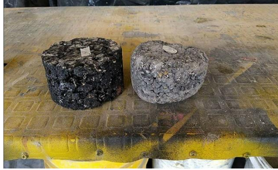
Fotografía 34. Muestras antes (izquierda) y después del ensayo (derecha)
