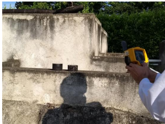
Fotografía 30. Toma de temperatura de las muestras expuestas al sol.
