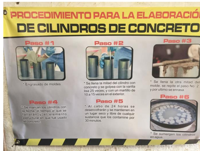
Imagen 3. Cartel proceso ensayos resistencia de concreto
