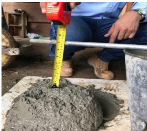
FIGURA 9. Medición de asentamiento.
