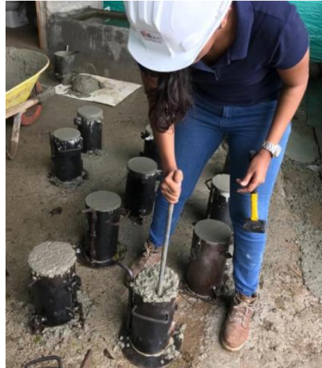
FIGURA 10. Elaboración de cilindros de concreto.
