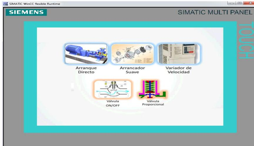
Se creó un menú principal para la realización de las pruebas de los objetos, el cual permite escoger el objeto que se desea probar. Mediante los HMI en WINCC FLEXIBLE fue posible sustentar y capacitar a los ingenieros acerca del funcionamiento de los objetos programados.
