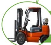
Montacargas: Hasta 2.5 toneladas. Manipular cargas de gran peso, paletizadas o almacenadas.
