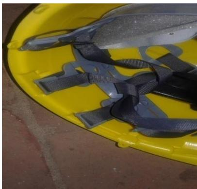
*Figure 4* Casco dieléctrico con sistema de suspensión incorrecto
