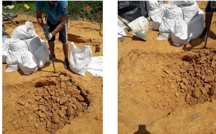
Fotografía 1. Excavación y toma de muestra por medio de técnica apique (Autores)
