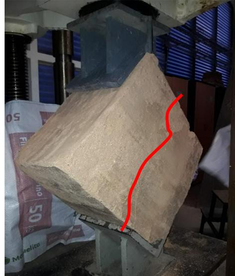
Fotografía 11. Ensayo tracción indirecta en muretes 1 (Autores)
