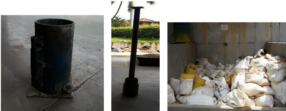
Fotografía 3. Herramientas y material utilizado para proceso constructivo de cilindros.
