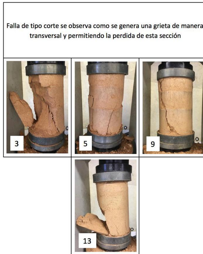
Fotografía 7. Compresión cilindros falla tipo corte (Autores)
