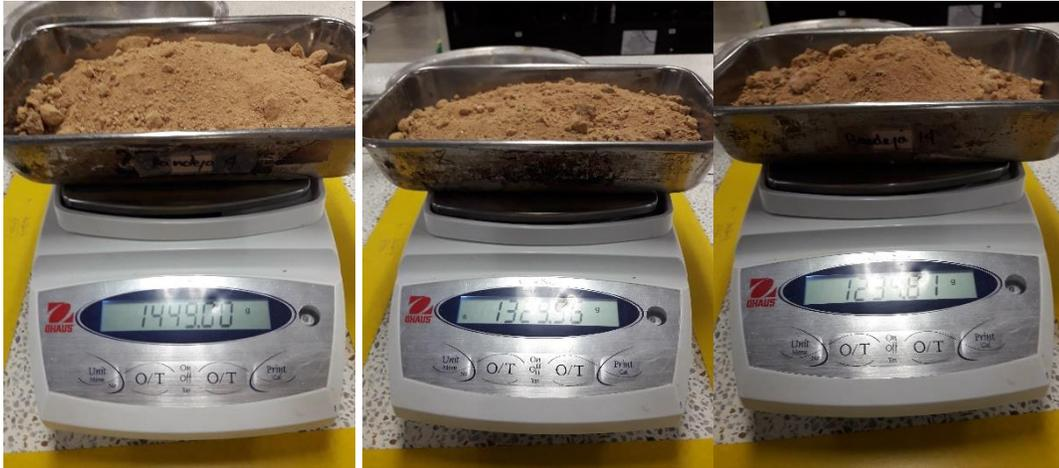
Fotografía 2. Muestras tomadas para realización de ensayo granulométrico. (Autores)
