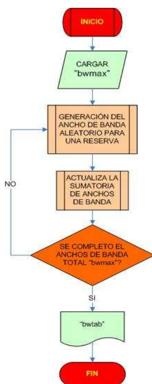
Figura 22. Diagrama de flujo del módulo de Ancho de Banda Aleatorio
