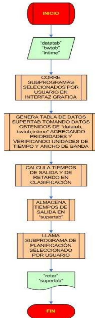
Figura 29. Diagrama de flujo del simulador de Reservas Fijo
