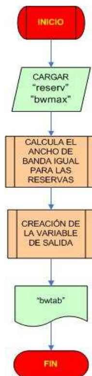
Figura 21. Diagrama de flujo del módulo de Ancho de Banda Fijo
