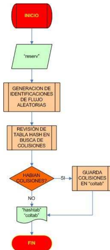
Figura 25. Diagrama de flujo del módulo de Generación de tabla de colisiones
