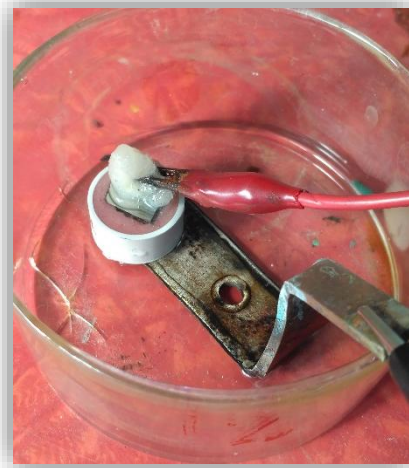
Figura 9 - Electrólisis de acero HP en Hidróxido de Potasio.
