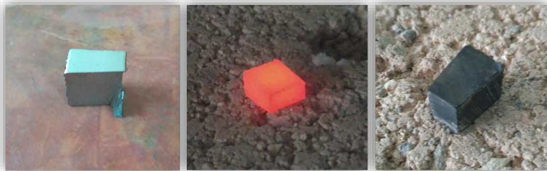
Figura 4 - Comparación de muestras de acero HP-modificado con Nb del antes, durante y después de llevarlas al horno.
