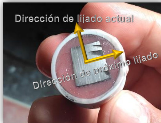
Figura 6 - Direcciones de lijado a mano
