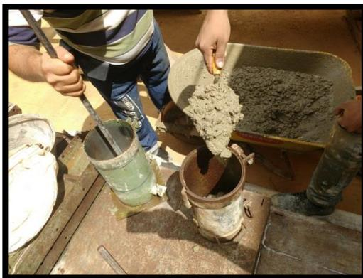
Imagen 7. Preparación de cilindros para fallar. Fuente: Autor
