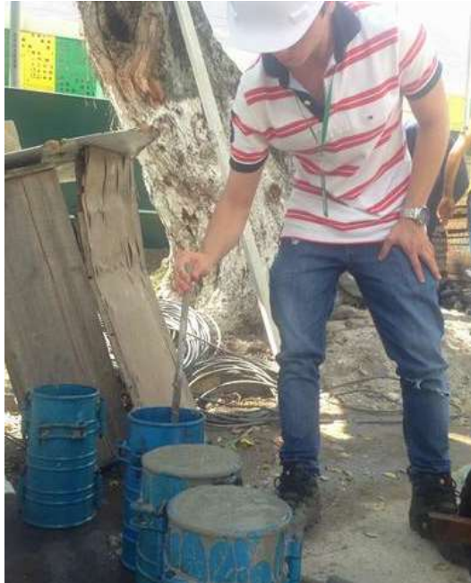
Figura 6. Toma de muestras para ensayo a compresión. Fuente: Propia.
