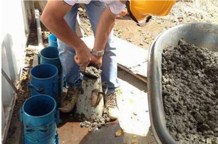
Figura 4. Llenado del cono Abrams. Fuente: Propia.
