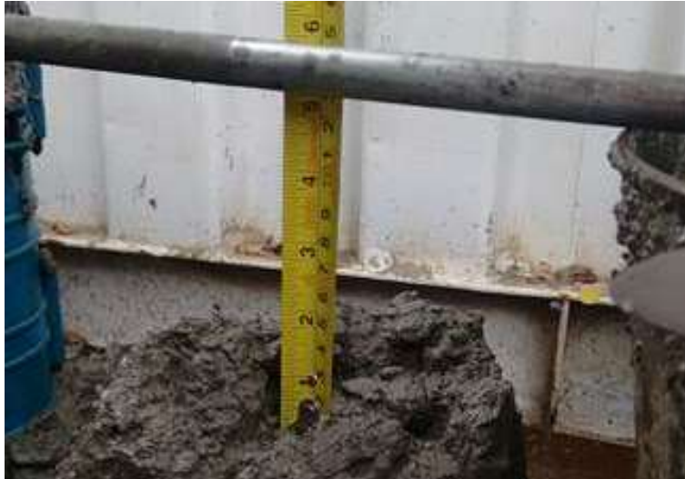
Figura 5. Medición del asentamiento de un concreto. Fuente: Propia.
