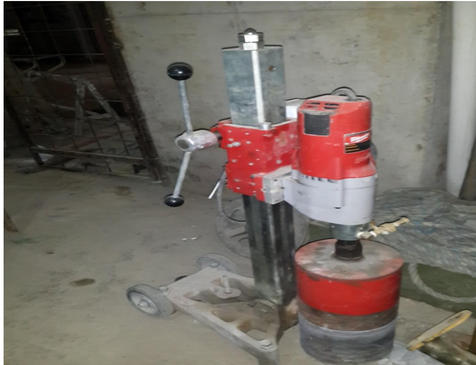
Figura 23: Imagen equipo principal TALADRO SACA NÚCLEOS MILWAUKE TSN-01
