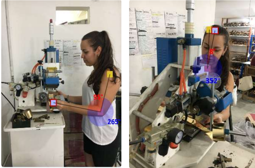
Figura 38. Posiciones críticas del emplantillado: segunda postura para colocar sello a la sandalia Fuente: Elaboración propia utilizando Ergonautas-Toolbox-Ruler
