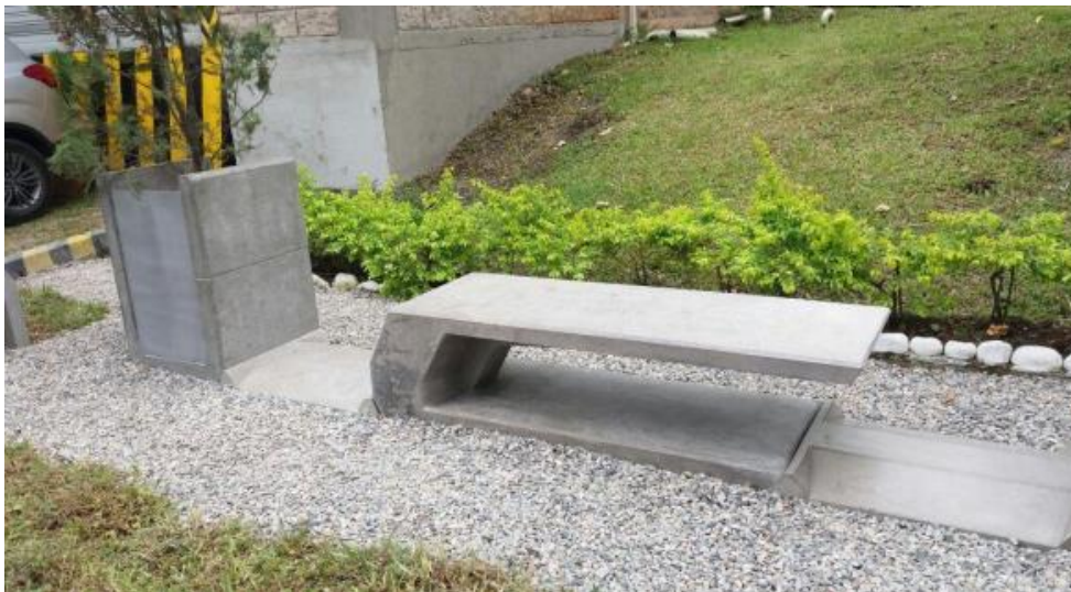
Figura 31. Banca y cestos de plantas elaborados con material residual.
