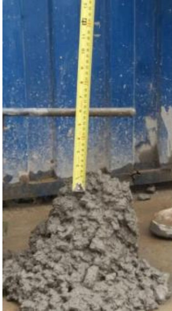
Figura 9. Prueba de slump al concreto de la losa.
