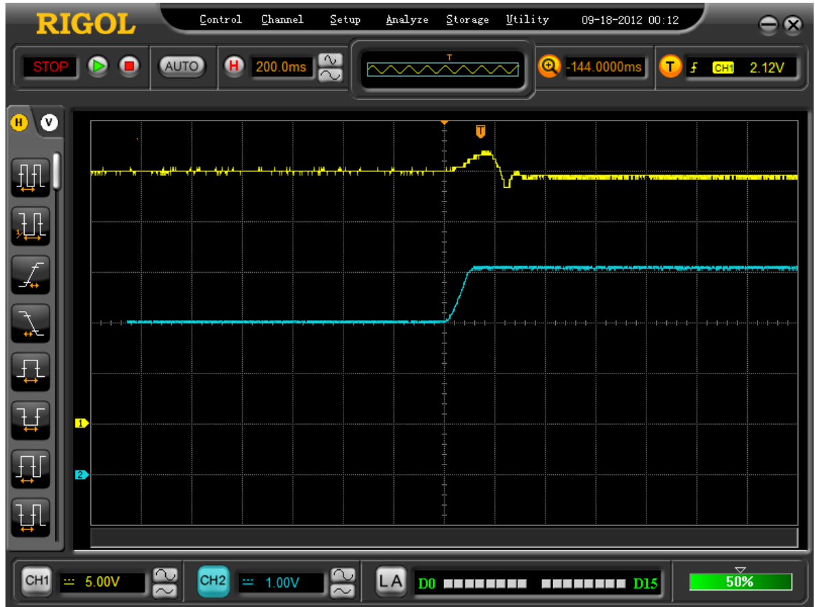
Gráfico 26. Respuesta de la señal de salida ante un escalón.
