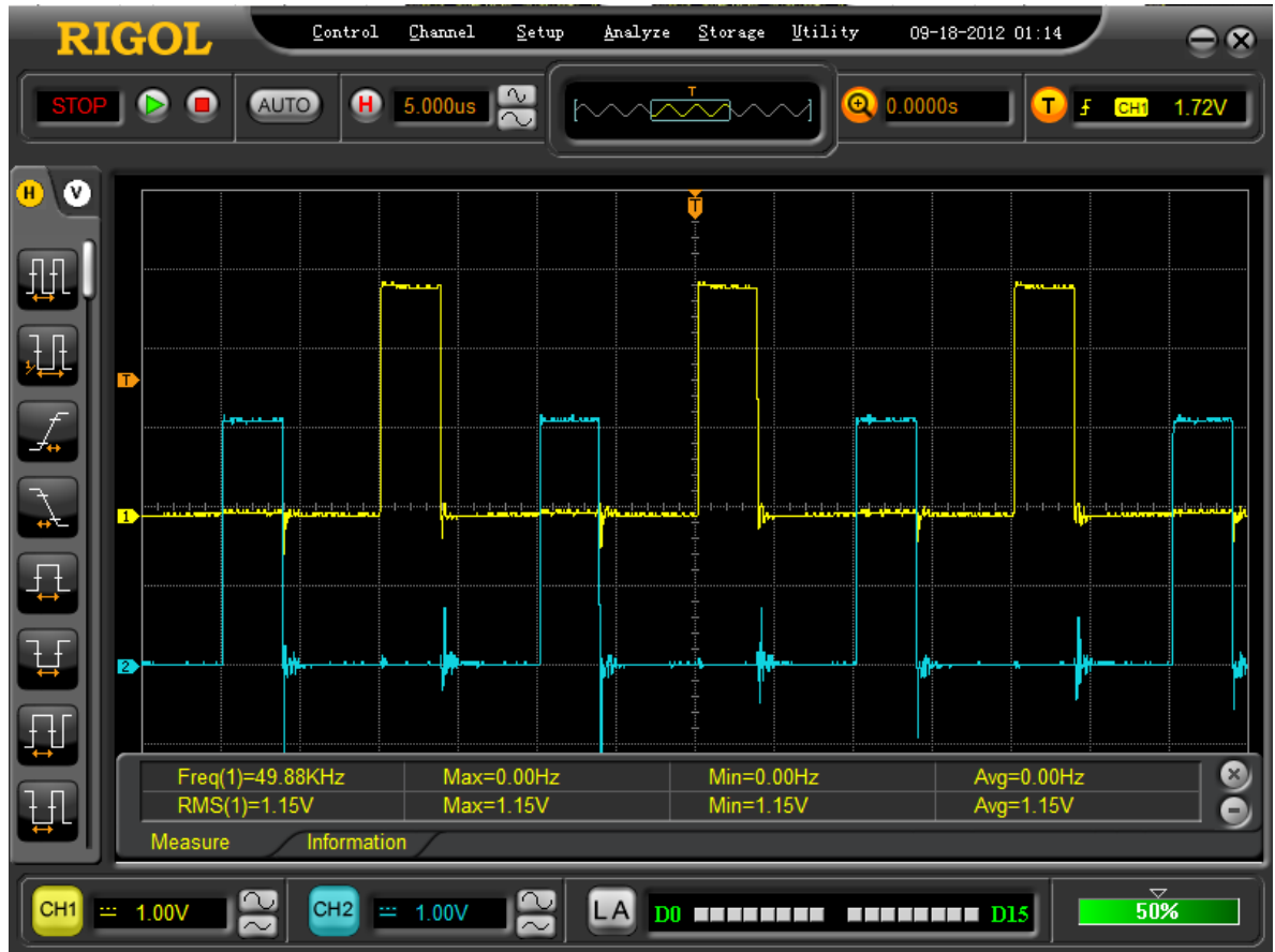
Gráfico 24. Señal de control PWM Convertidor DC/DC
