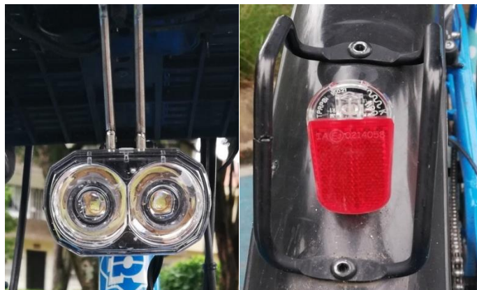
Imagen 31. Luz delantera y trasera de la bicicleta Encicla.
