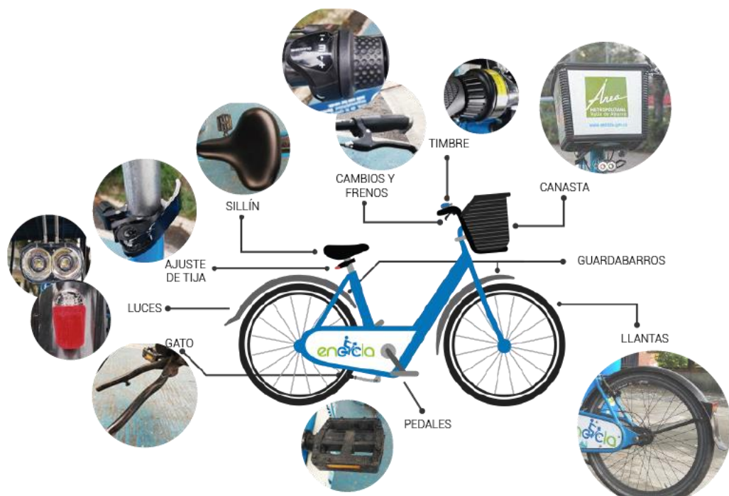
Imagen 12. Bicicleta Encicla Modelo 2019 y sus partes.
