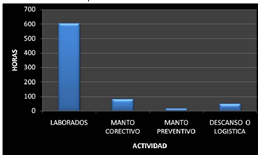
Figura 10. Distribución de tiempo. Motoniveladora John Deere 672B
