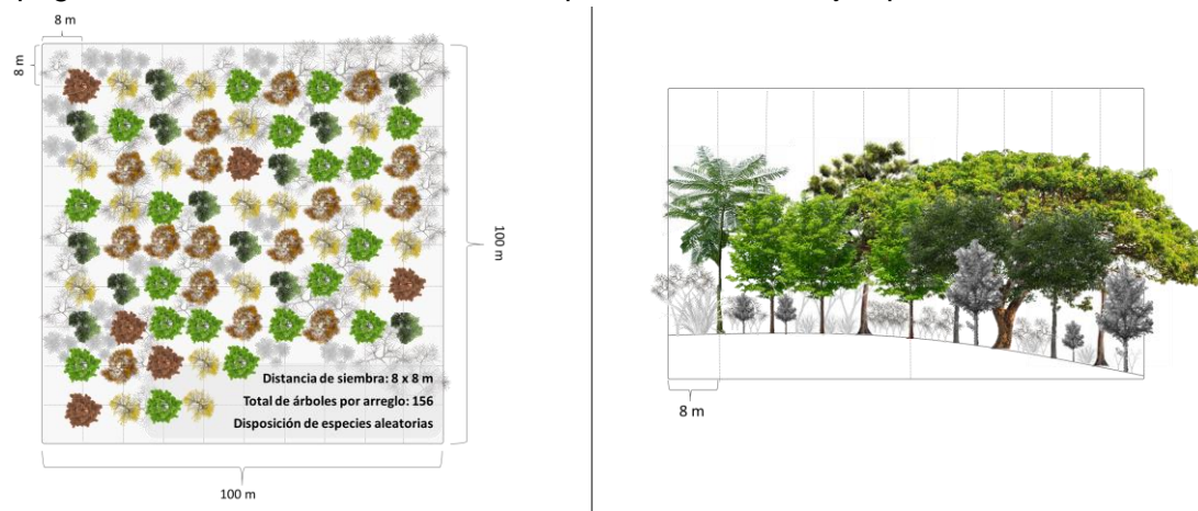
Figura 4. Esquema planta y sección rastrojeras y proceso sucesional natural y de la rastrojera con línea de tiempo
