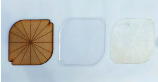
Figura 5. Obtención de la preforma. (a) Matriz en MDF. (b) Molde termoformado en acetato de vinilo. (c) Lámina resultante del vaciado de material. (Fotografías de los autores).
