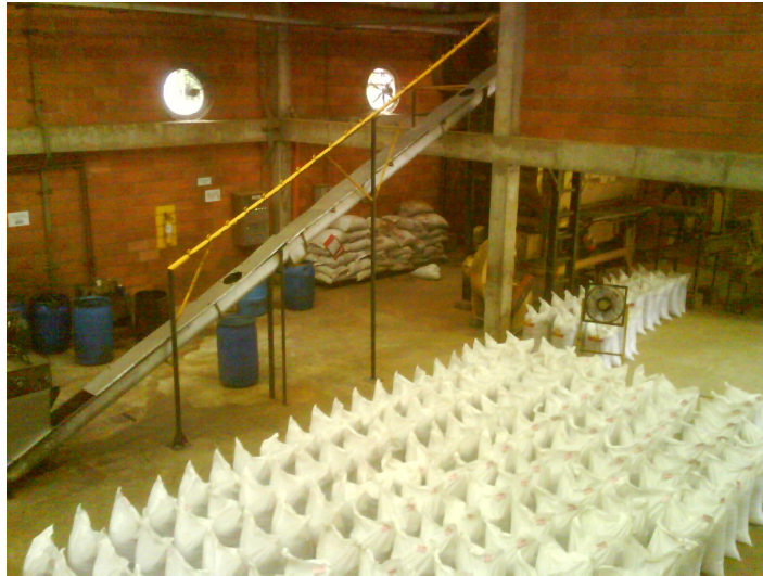
Figura 19. Transportador del producto de la harina de vísceras desde la prensa hacia el molino (cortesía Avides Mac Pollo 2008)
