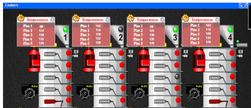
Figura 28. Primer pantallazo – temperaturas desplegadas. Sistema SCADA cocedores fríjol soya (cortesía Avidesa Mac Pollo 2008)
