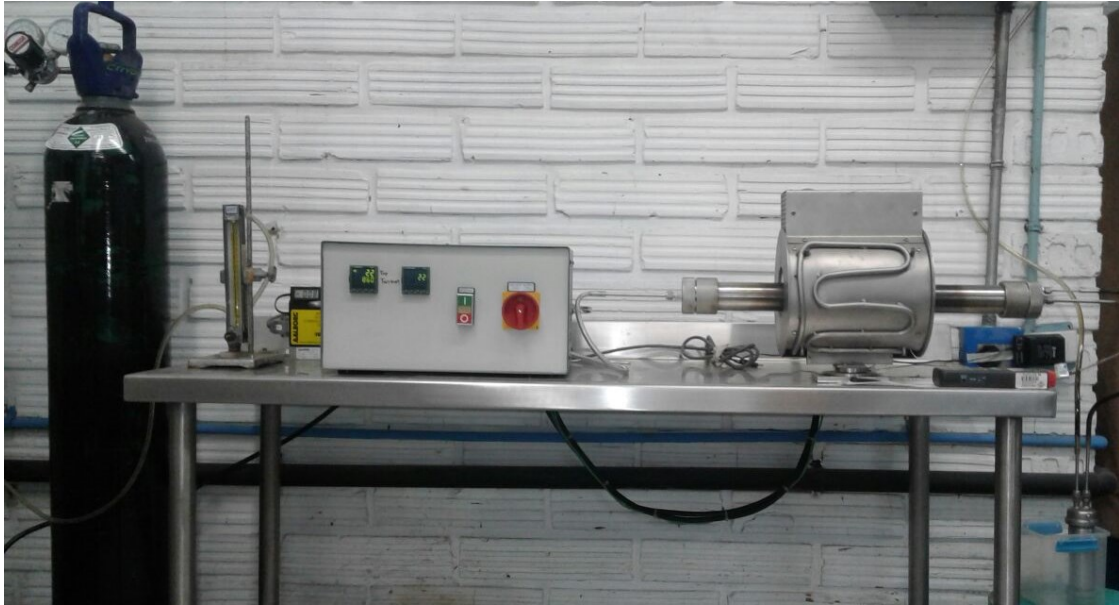
Figura 11. Montaje de la unidad de tratamiento térmico implementado en la activación química.
