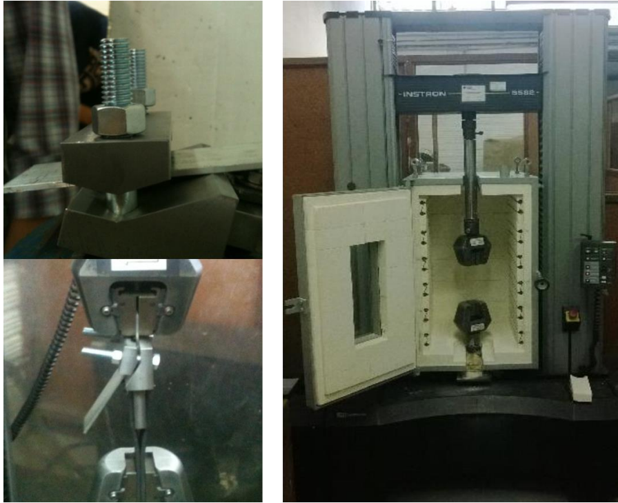
Figura 2-15. Montaje del proceso ECASD en la máquina de tracción
