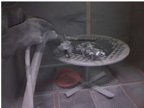
Figura 32. Proceso de Sand Blasting en los álabes
