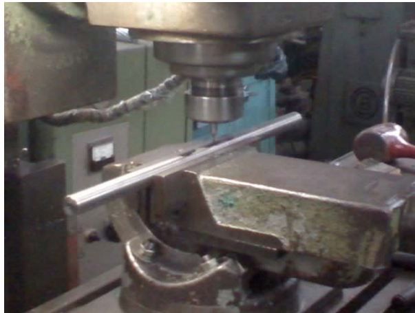
Figura 39. Proceso de fabricación de la cuña
