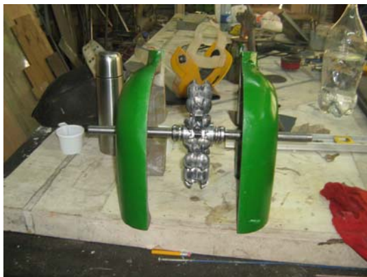
Figura 49. Ensamble Turbina Pelton en el área de Mantenimiento
