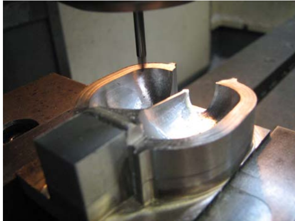
Figura 22. Maquinado álabe Pelton en Fresadora C.N.C
