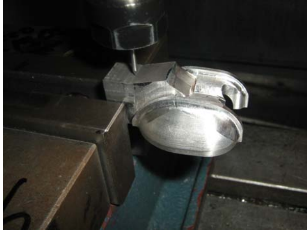
Figura 28. Maquinado álabe Pelton en Fresadora C.N.C
