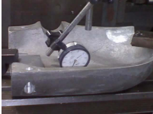
Figura 45. Apertura de los orificios para el eje
