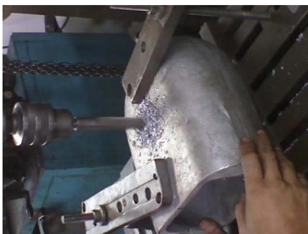
Figura 44. Apertura de los orificios para el eje
