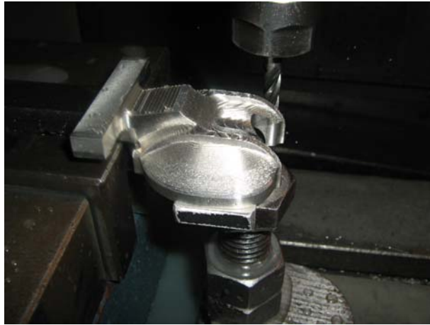
Figura 23. Maquinado álabe Pelton en Fresadora C.N.C
