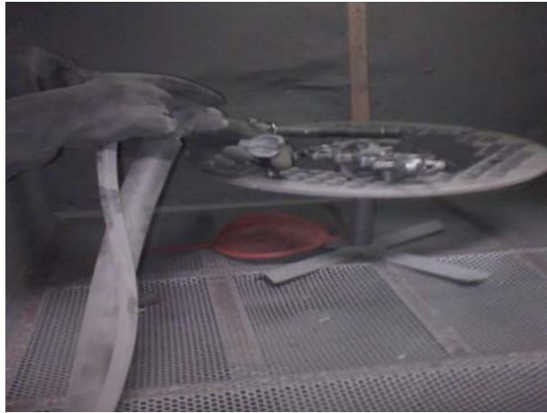
Figura 33. Proceso de Sand Blasting en los álabes
