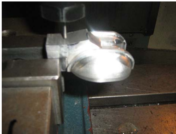
Figura 20. Maquinado álabe Pelton en Fresadora C.N.C
