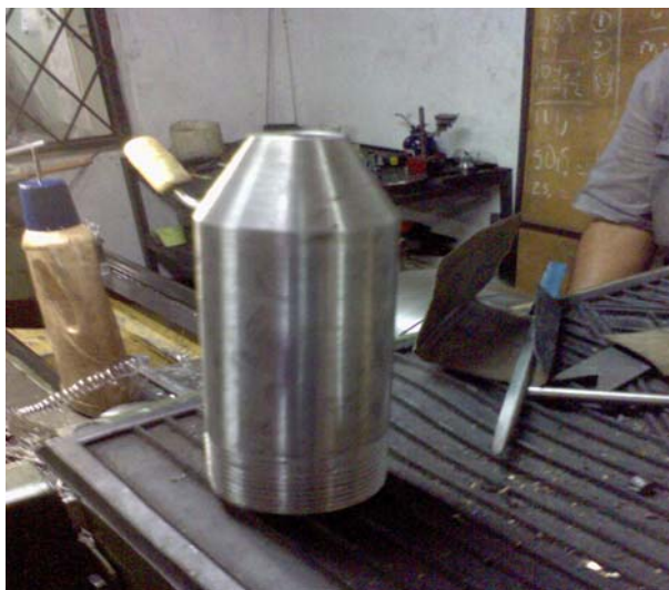
Figura 41. Proceso de fabricación de los inyectores
