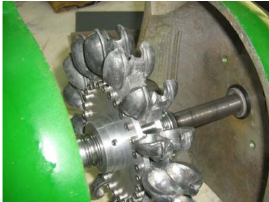
Figura 48. Vista interior de la Turbina Pelton
