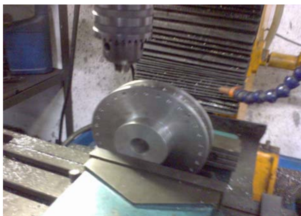
Figura 38. Fabricación del rodete
