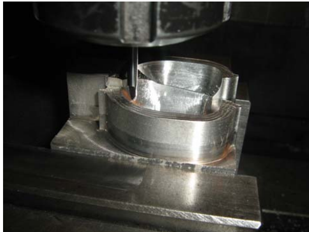
Figura 25. Maquinado álabe Pelton en Fresadora C.N.C
