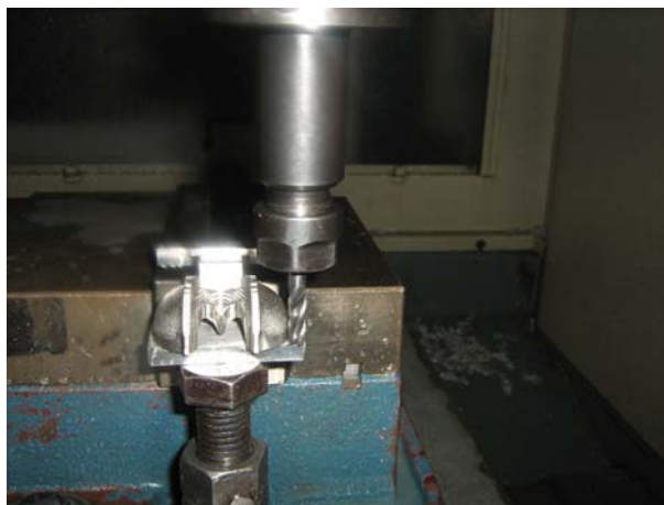
Figura 21. Maquinado álabe Pelton en Fresadora C.N.C
