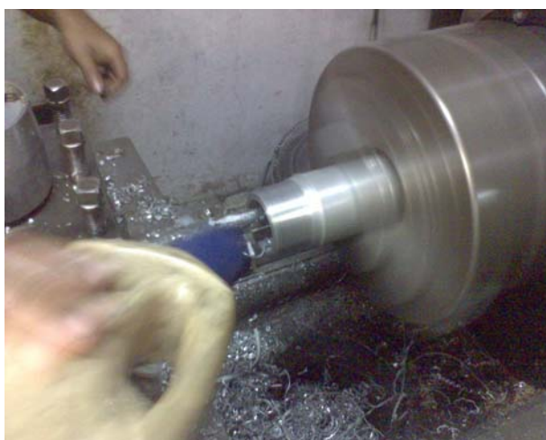
Figura 43. Proceso de fabricación de los inyectores
