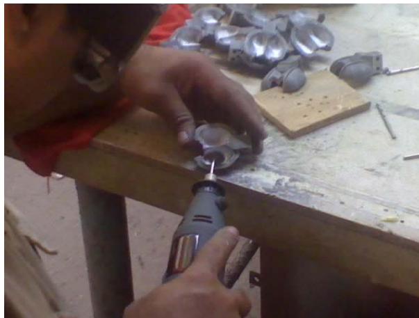
Figura 37. Proceso de pulido de los álabes
