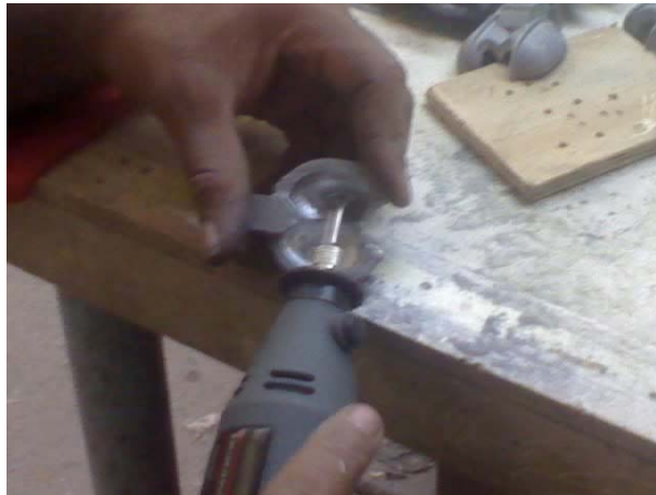
Figura 36. Proceso de pulido de los álabes
