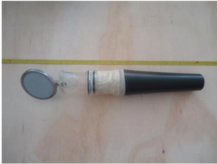
**Figura 7. Microfono Estetoscopio**
