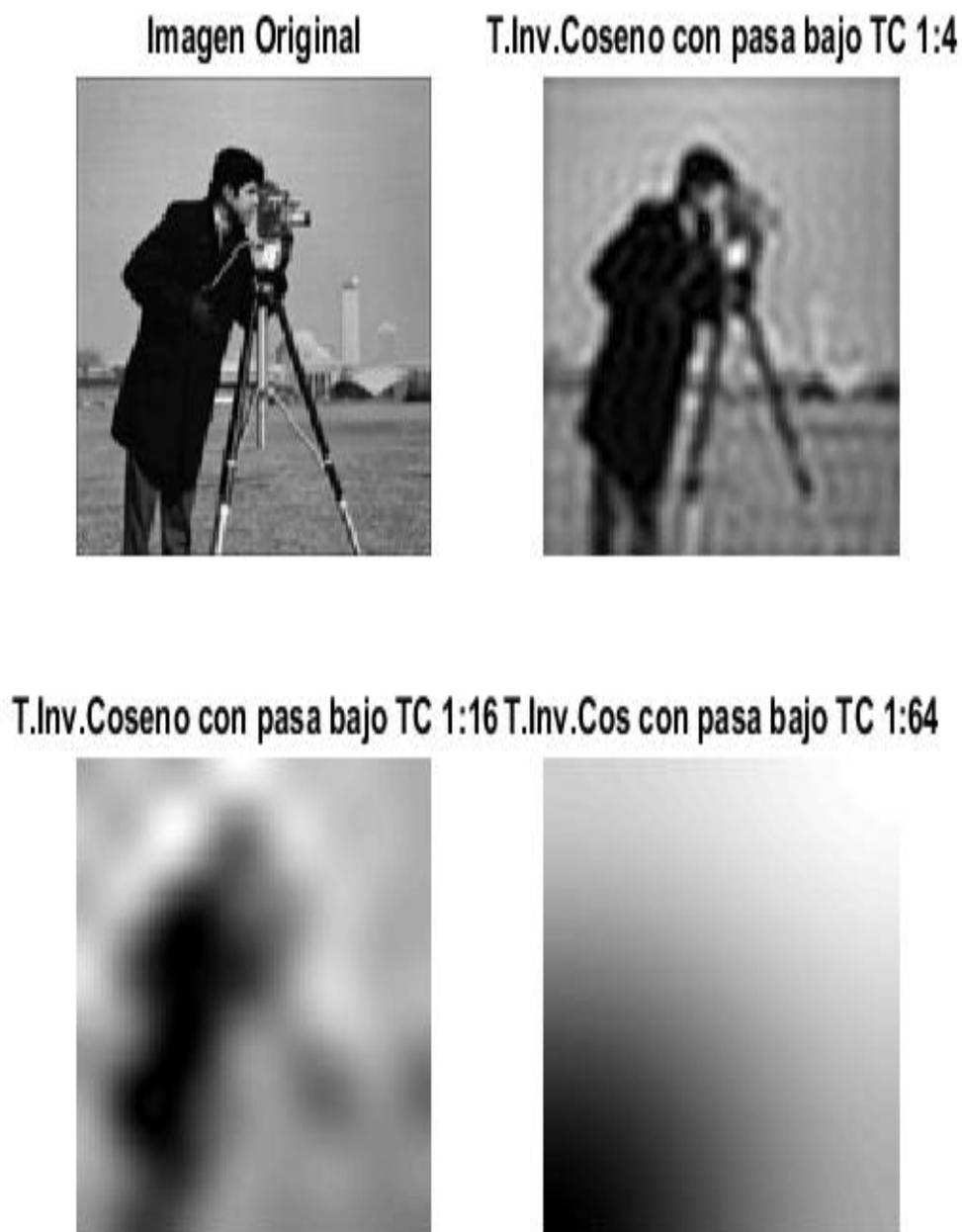
Figura 10. Compresión usando la Transformada Discreta de Coseno. Tasa de compresión 1:4, 1:16 y 1:64.
