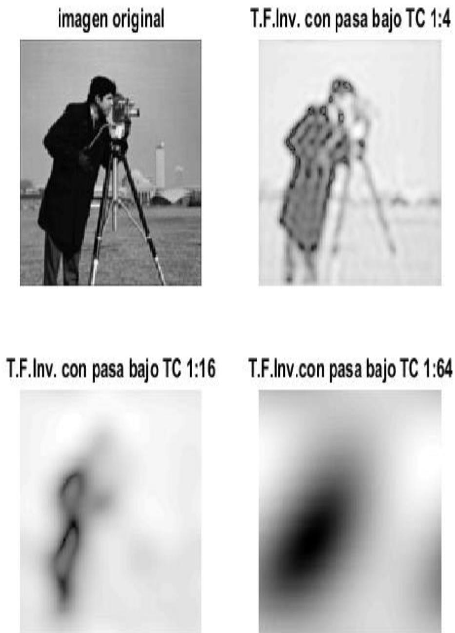
Figura 8. *Compresión usando la Transformada de Fourier. Tasa de compresion 1:4, 1:16 y 1:64.*
