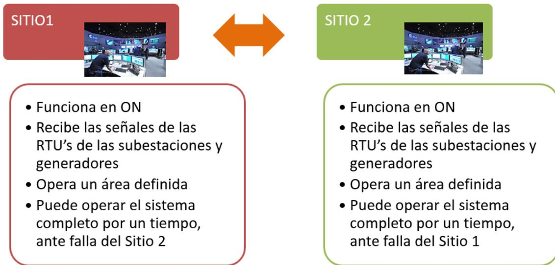
**Figura 13.** Esquema de Funcionamiento Operación Distribuido
