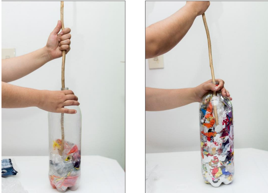
Figura 6. Compactación de las envolturas
