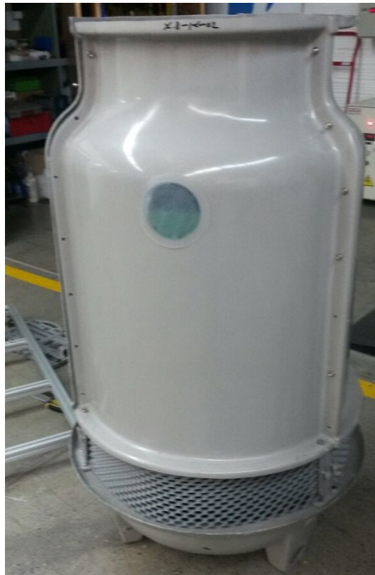
Figura 29. Torre de enfriamiento
