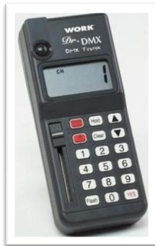
Utilizando el conector XLR del Dr. DMX *tester* se realiza la conexión a la tarjeta que se emplea para verificar la rutina de captura de datos del microcontrolador
