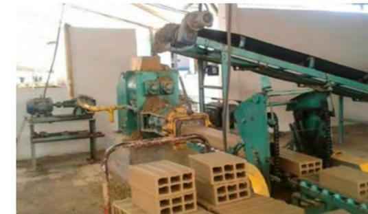
Figura 11. Cortadora automática
