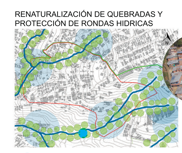
RENATURALIZACIÓN DE QUEBRADAS Y PROTECCIÓN DE RONDAS HIDRICAS ● Zona especial de protección por nacimiento y desembocaduras ● Configuración arborea para la protección de la ronda hídrica y su naturalización ● Sistema de fitoremediación para limpiar el agua
