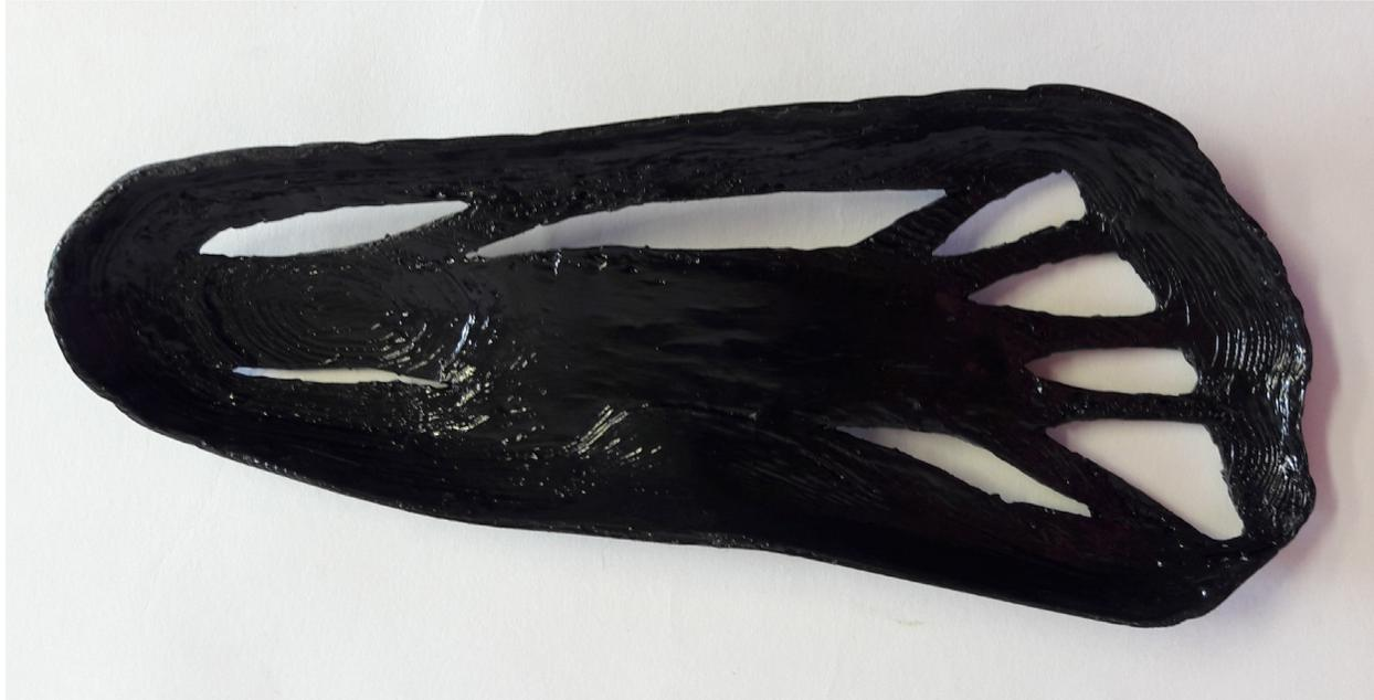
**Imagen 64:** Foto por Camila Agudelo. El resultado final fue un prototipo de plantilla con agujeros que sigue la musculatura del pie, además tiene la forma del pie en reposo, lo que quiere decir que no es plana, sino que tiene el levantamiento de los arcos y el soporte para que el talón mantenga su postura correcta. 2017
