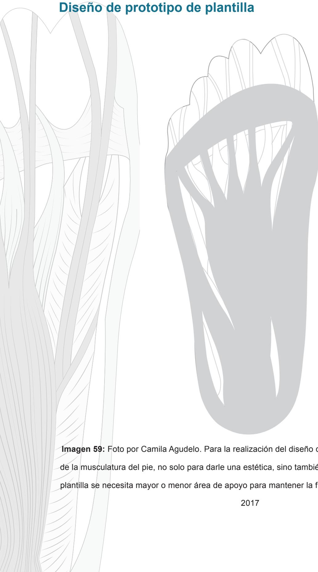
**Imagen 59:** Foto por Camila Agudelo. Para la realización del diseño de tomo como referencia el calco de la musculatura del pie, no solo para darle una estética, sino también para saber en qué partes de la plantilla se necesita mayor o menor área de apoyo para mantener la fuerza de esta durante la marcha.
