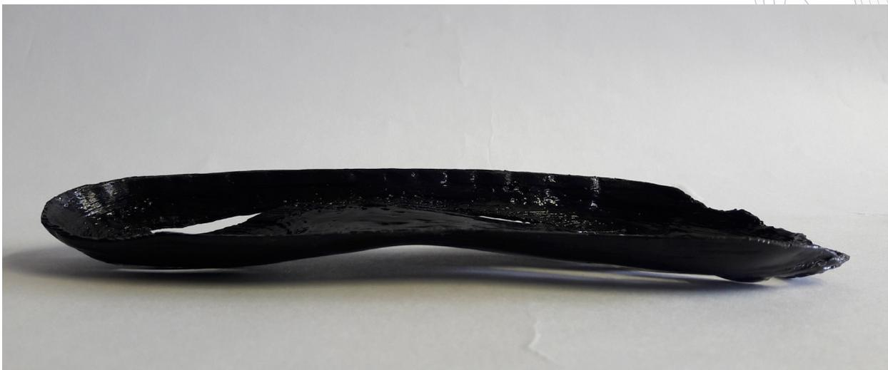
**Imagen 65:** Foto por Camila Agudelo. El prototipo final se realizó por medio de impresión 3D en PVA negro. El modelo no tiene soporte para los dedos pues luego de la investigación no se consideró necesario ponerlo. 2017
