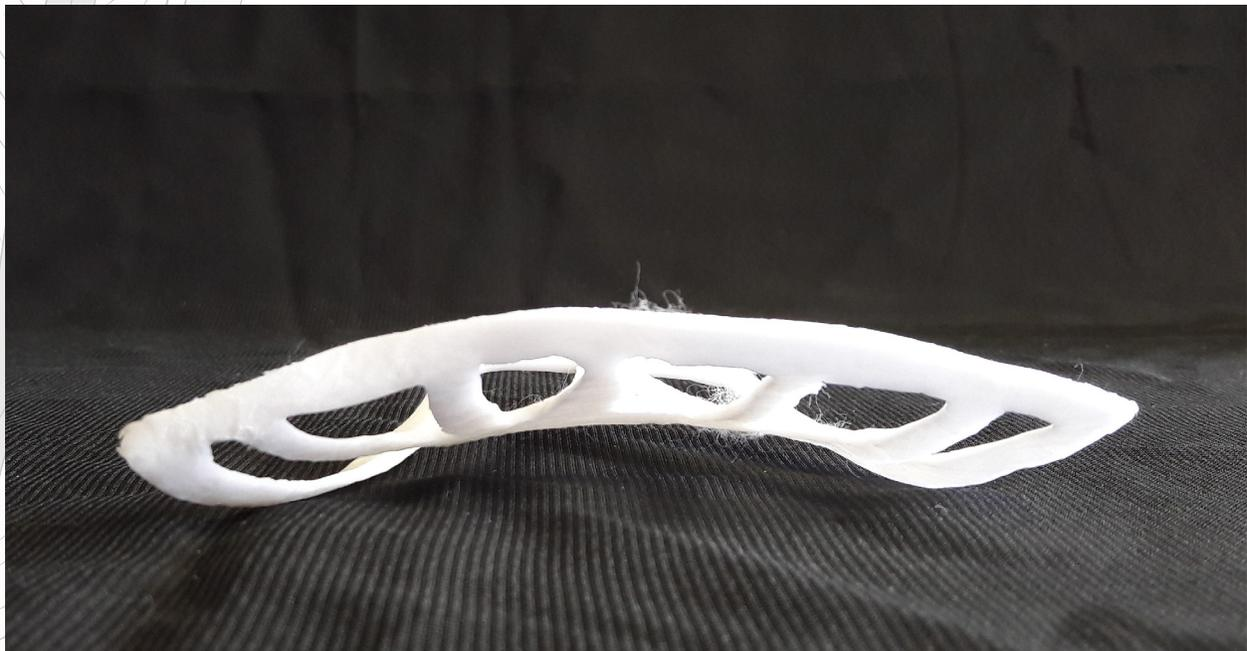
**Imagen 49:** Foto por Camila Agudelo. Se puede ver como a pesar de tener un tamaño pequeño y no cubrir toda la superficie de la planta del pie se levantan los arcos y mantienen su forma. 2017
