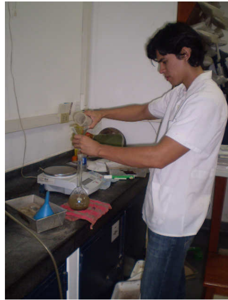
Fig. 4. adición de agua hasta la marca establecida
