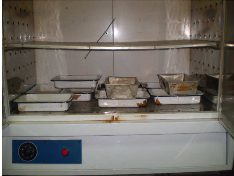
Fig. 8. Deposito para el secado de la muestra
