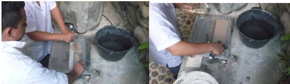
Figura 28. Vertido Mezcla Yeso – Caolín Aparato Refrentador.
