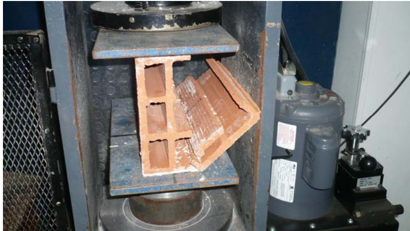
Figura 14. Ladrillo H – 10 Fallado.
