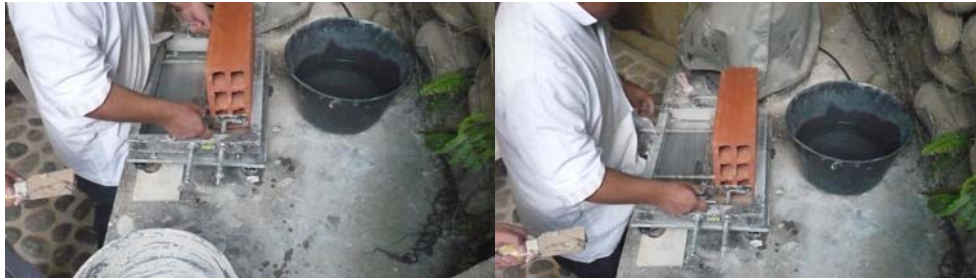
Figura 30. Ubicación de la Unidad ya Ajustada en el Refrentado.
