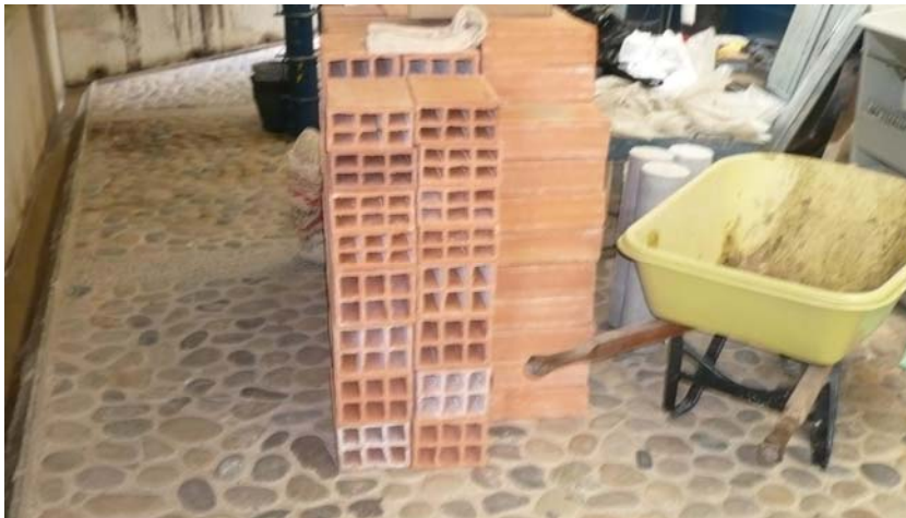
Figura 10. Secado Natural Piezas de Mampostería
