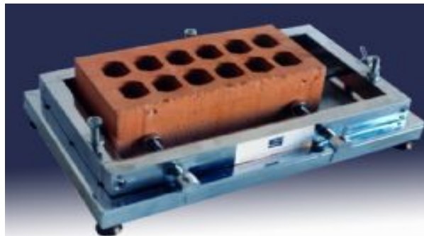
Figura 15. Refrentador de mampostería patentado en ESPAÑA
