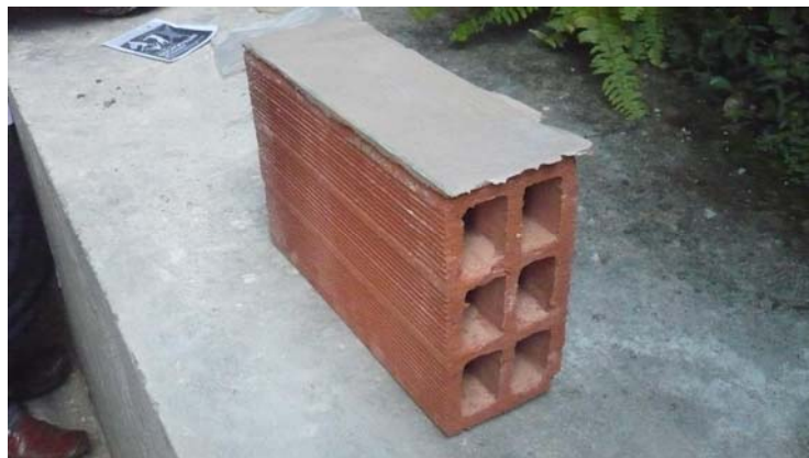
Figura 34. Ladrillo Refrentado por una Cara.
