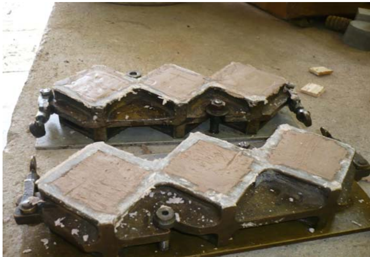
Figura 3. Vertido de yeso – caolín en moldes.
