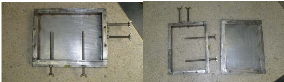
Figura 16. Equipo refrentador de mampostería en acero inoxidable.
