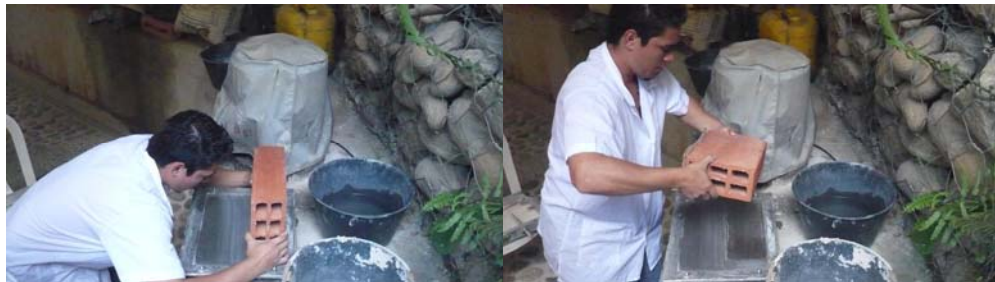
Figura 33. Retiro de la Unidad de la Base del Aparato.
