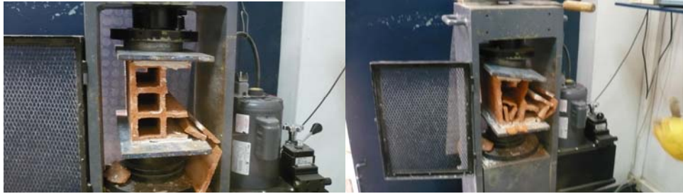
Figura 48. Bloque H-15 Ensayado a Compresión.
