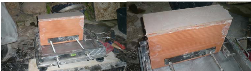
Figura 35. Refrentado Otra Cara de la Unidad.
