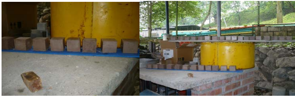
Figura 5. Cubos de YESO/CAOLIN listos para fallar en el laboratorio
