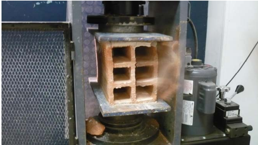
Figura 46. Falla Inminente del Bloque.
