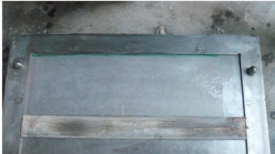
Figura 26. Ubicación del Límite de Refrentado.
