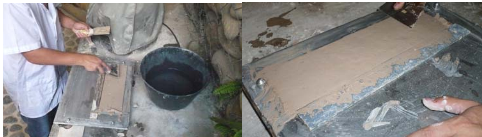
Figura 29. Enrasada de Mezcla Yeso – Caolín.
