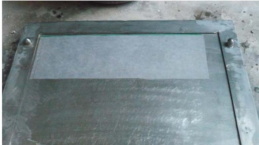
Figura 25. Filtro Húmedo de Papel Mantequilla
