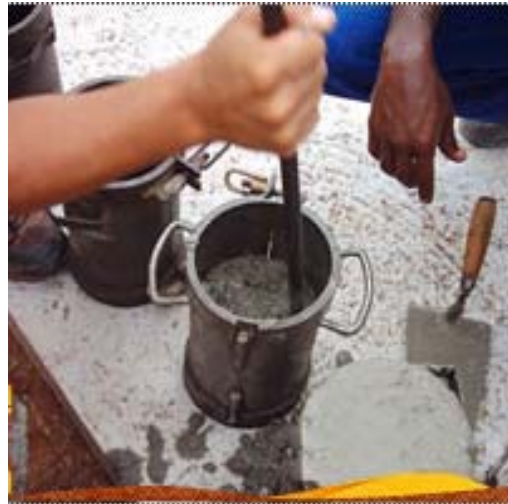
Figura 18. Vibrado de la mezcla.
