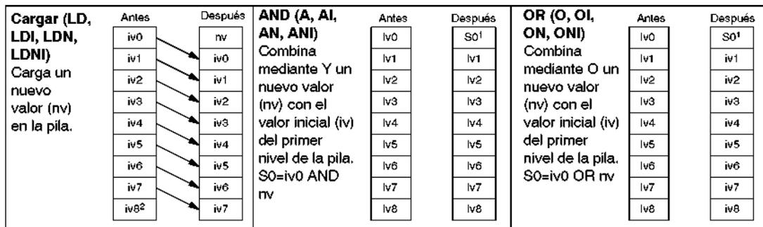
1 S0 identifica el valor calculado que se guarda en la pila lógica.
