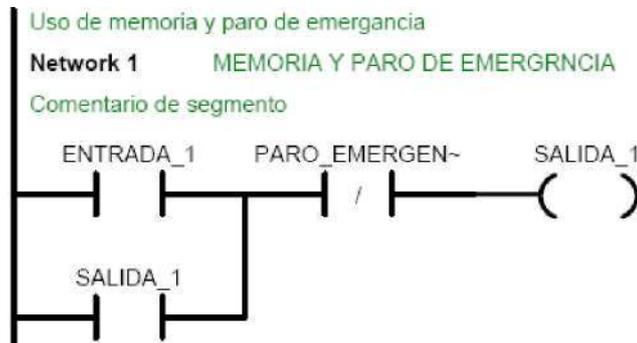
Network 1// el contacto ENTRADA\_1 va a actuar como un pulsador entonces la SALIDA\_1 se activa y se va mantener gracias a que se cierra el contacto SALIDA\_1 que esta en paralelo con el contacto de la ENTRADA\_1 y la única manera de salirse de esta operación es con el contacto PARO\_EMERGEN que va a hacer que se habrá el circuito.
