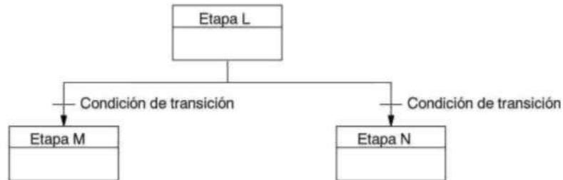
Figura 6-35 Dirigir una cadena secuencial a otra, dependiendo de la condición de transición
