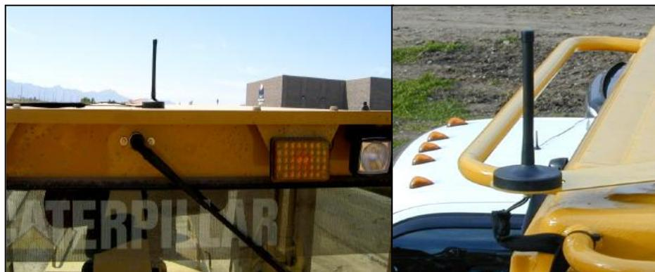
**FIGURA 37.** Fotos de la forma correcta de instalar las antenas
