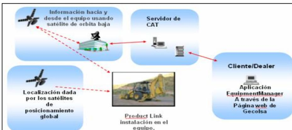
**FIGURA 7.** Transmisión de datos del Product link
