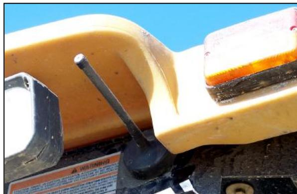
**FIGURA 39.** Fotos de la forma incorrecta de instalar las antenas
