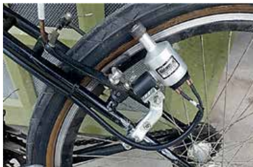
Imagen 1. Parte trasera de la bicicleta, Dinamo.
