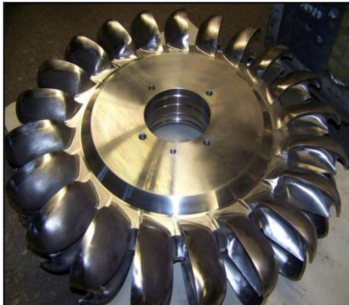
Figura 2. Rodete Turbina Tipo Pelton - Fuente Gugler [7]
