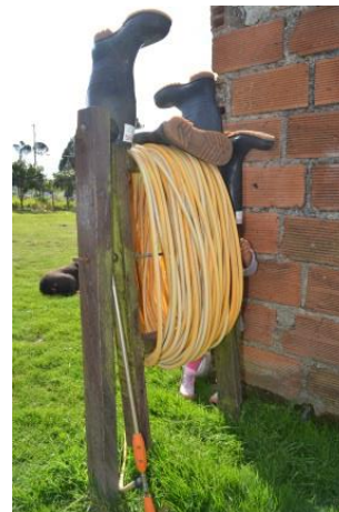
Fotografía 2 - Sistema creado a partir de la creatividad del agricultor para enrollar más fácilmente su manguera, además le sirve para fines alternativos tales como enrollar y colgar su calzado.
