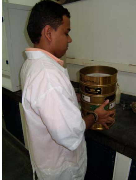
Fig 5 Pasar el material seleccionado a través de la serie de tamices
