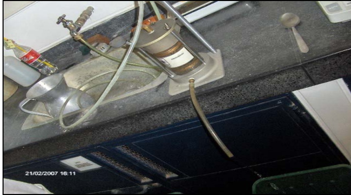
Fig. 17 Abrir las válvulas permitiendo el paso del agua y la saturación de la muestra
