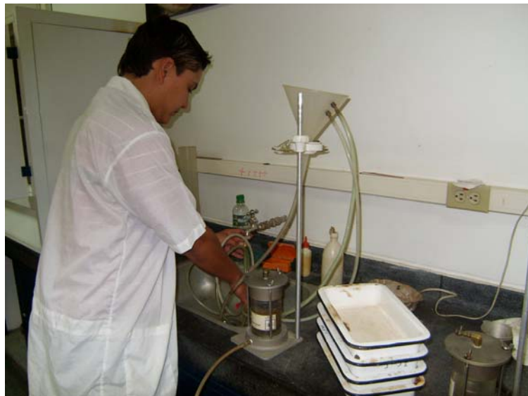
Fig. 14 Armar el aparato de permeabilidad de cabeza constante
