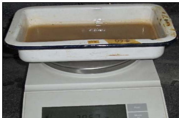
Fig. 11 Pesar el matraz con agua y suelo registrando su temperatura
