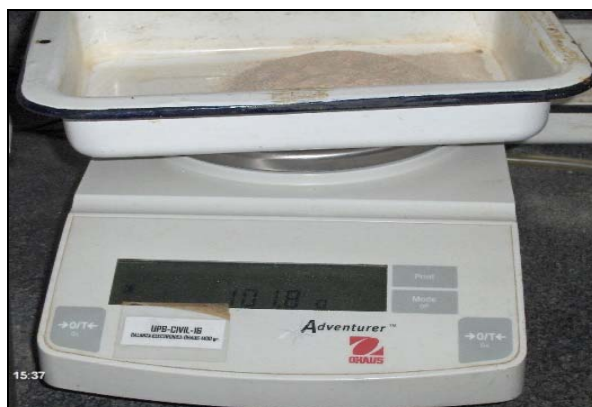
Fig. 12 Pesar la muestra de suelo antes y después de llevar al horno
