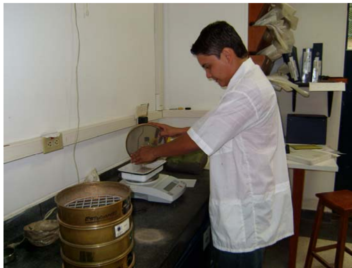
Fig. 6 Pesar el material retenido en cada tamiz.
