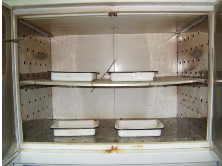
Fig. 19 Pesar la muestra de suelo antes y después de llevar al horno
