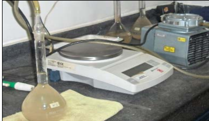
Fig. 11 Pesar el matraz con agua y suelo registrando su temperatura
