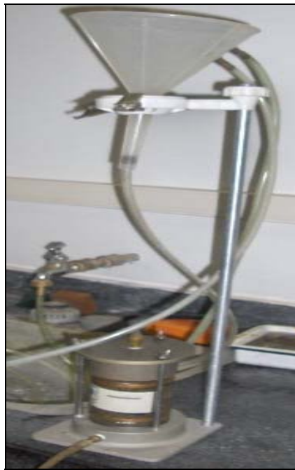
Fig. 16 Conectar la cámara al aparato de permeabilidad de cabeza constante
