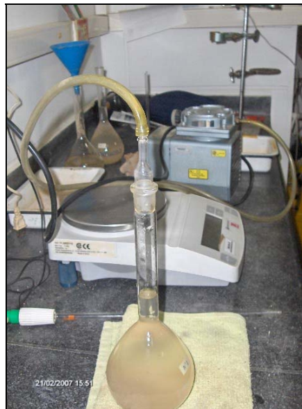
Fig.10 Agregar nuevamente agua hasta la marca del matraz y finalizar la eliminación de las burbujas de aire
