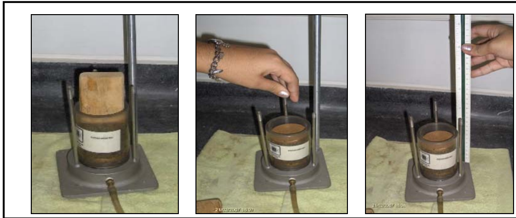
Fig. 15 Armar y pesar la cámara con la muestra de suelo seleccionada determinando las dimensiones de la misma
