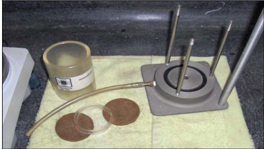
Fig. 13 Pesar la cámara y todos los elementos en la que estará contenida la muestra de suelo
