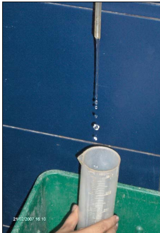
Fig. 18 Recolectar la cantidad de agua en un tiempo establecido y medir la temperatura
