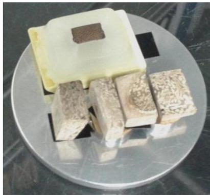
Figura 13. Preparación de muestras para microscopía electrónica de barrido (SEM).
