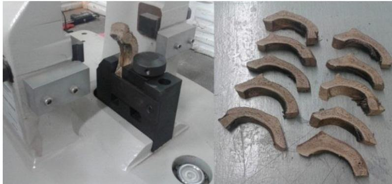
Figura 18. Muestras de la olla de mono para prueba de impacto.
