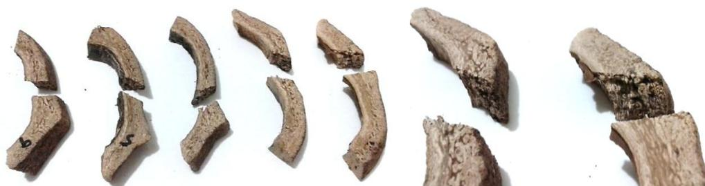
Figura 32. Tipo de fractura en la muestra por prueba de impacto.
