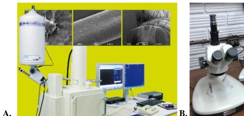
Figura 11. A. Microscopio electrónico de barrido (SEM). – B. Estereomicroscopio.
