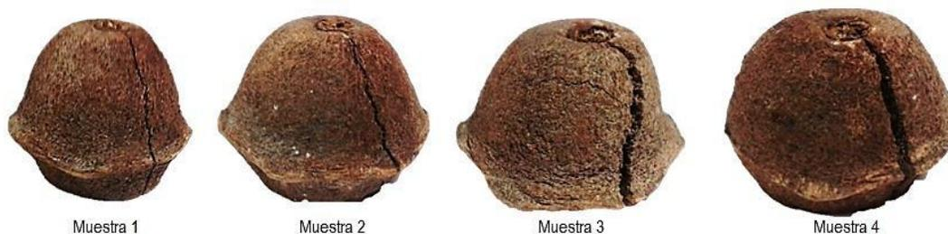
Figura 29. Fractura de las muestras después de la prueba de compresión.
