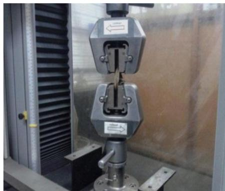
Figura 16. Máquina de ensayos universales para prueba de tensión.
