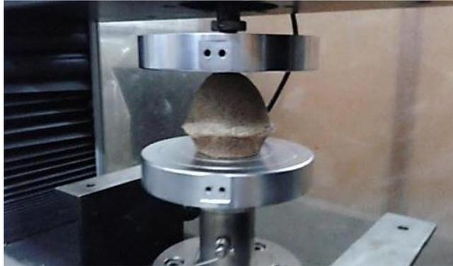
Figura 17. Máquina de ensayos universales para prueba de compresión.
