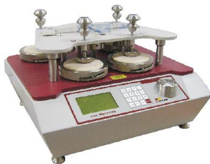
Figura 24. Equipo de abrasión Martindale, modelo: M235, adquirido por la Universidad Pontificia Bolivariana Medellín [41].
