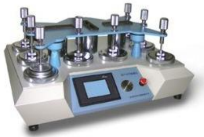
Figura 10. Textile Martindale Abrasor fabricado por Dongguan Haida Equipment Co, Ltd. [45].
