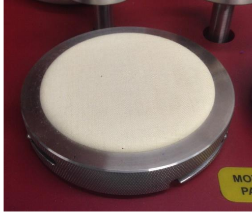
Figura 37. Estación del Martindale con el abrasivo.
