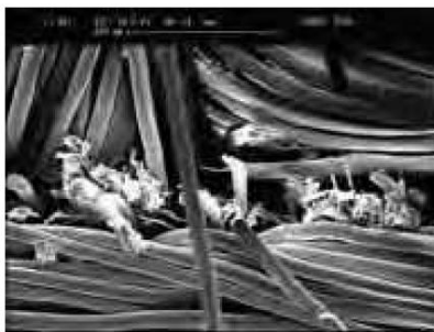
Figura 7. Rotura de fibra producido como abrasión contra la tela estándar de lana peinada [24].
