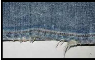
Figura 6. Productos de abrasión textiles - borde de los pantalones [24].
