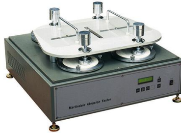
Figura 8. Martindale Comprobador de abrasión distribuido por Qualitest [43].
