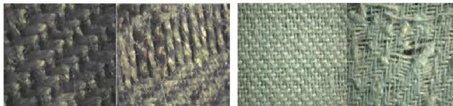
Figura 13. Apariencias superficiales de tejidos - antes (izquierda) y después (derecha) de la prueba de abrasión [24].
