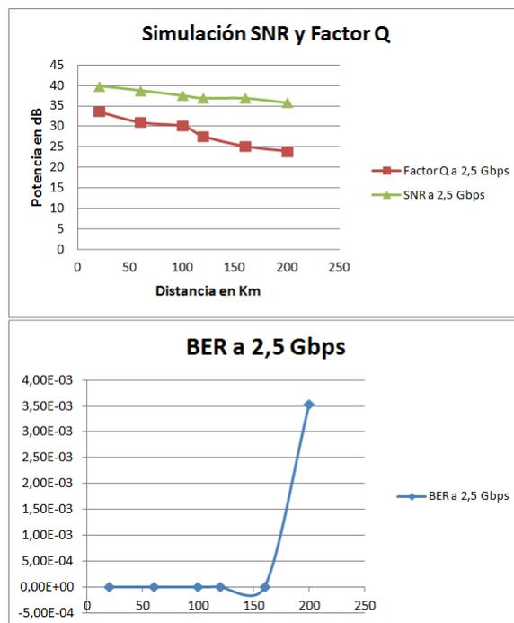
Ahora, el diagrama de Potencia Óptica para los diferentes resultados de simulación del enlace óptico tiene en cuenta: La tasa de transmisión de 2.5 Gbps, la Distancia en Km, Longitud de onda empleada. Esto se presenta en la Figura 40.
