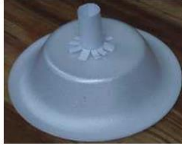
Figura 16. Diseño y sujeción del cuerpo de la bobina. Fuente: Guía para la construcción de un parlante de Tony Peñarredonda
