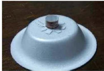
Figura 17. Elaboración del embobinado. Fuente: Guía para la construcción de un parlante de Tony Peñarredonda
