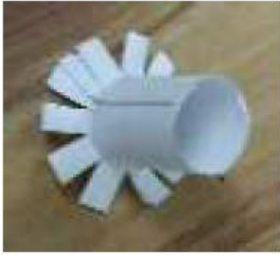
Figura 16. Diseño y sujeción del cuerpo de la bobina. Fuente: Guía para la construcción de un parlante de Tony Peñarredonda
