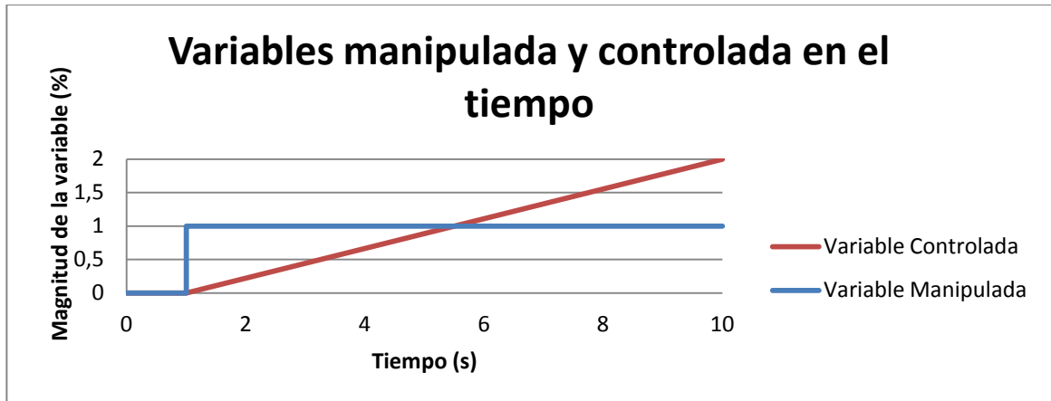
Gráfica 4. Comportamiento de un sistema integrador a un escalón en la variable manipulada
