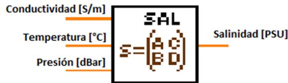
Figura 8. Módulo para el cálculo de la salinidad
