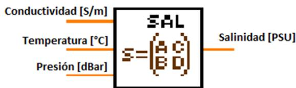
Figura 7. Módulo para el cálculo de la salinidad
