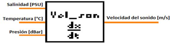
Figura 12. Módulo para el cálculo de la velocidad del sonido
