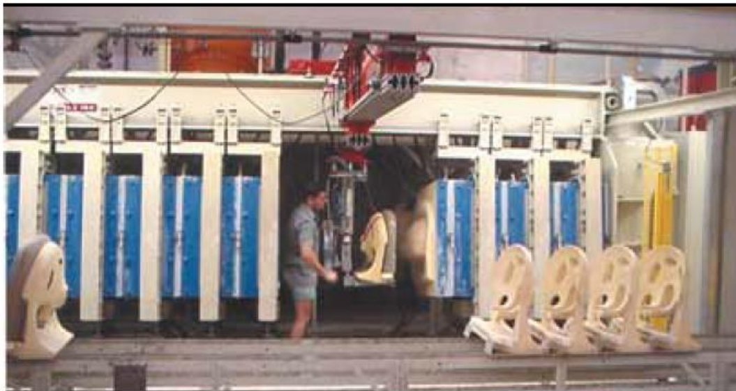
Ilustración 7. Máquina de alta presión para colaje de lavamanos
