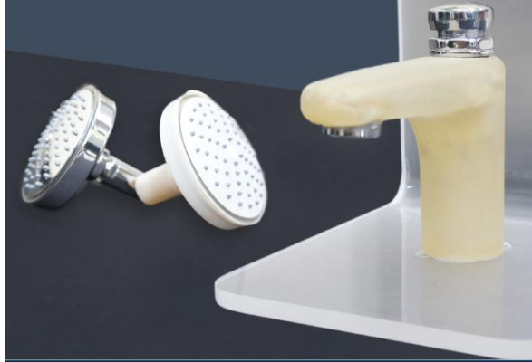
Ilustración 90. Prototipos de Griferías HELVEX de México por impresión a chorro.
