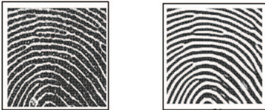
Ilustración 4: Filtración de Gabor.
