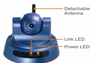
Fig. 52. Cámara TRENDnet TV-IP400W. Fuente TRENDnet TV-IP400W. [15]
